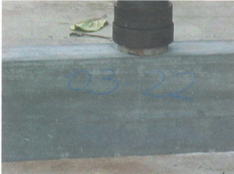
FOTO 06 – Posicionamento da viga no início do ensaio (Amostra 03 – concreto Fck 22Mpa).
