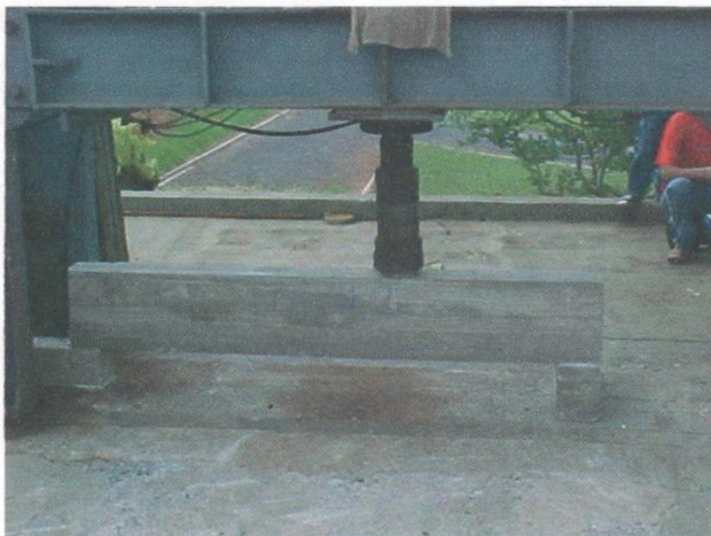
FOTO 01 – Posicionamento da viga no início dos ensaios (Amostra 01 – concreto Fck 16Mpa).
